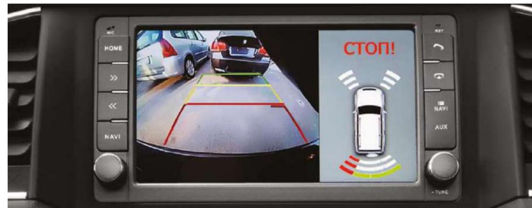
Парковочный ассистент отображает на экране ММС информацию, получаемую от камеры заднего вида и датчиков парковки
