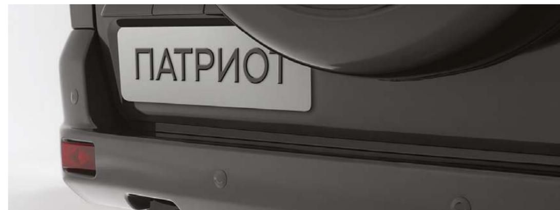
Задние датчики парковки на бампере и камера заднего вида в ручке задней двери
